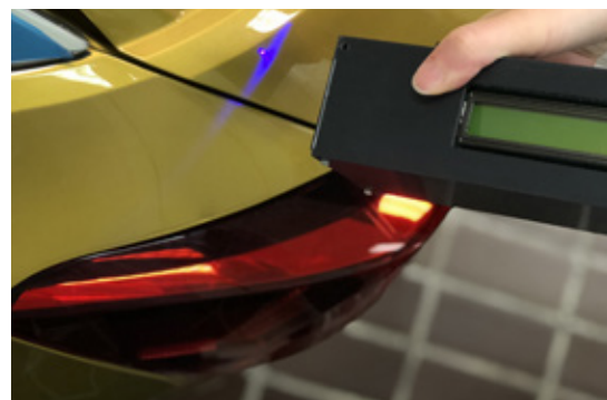
SCANNER LASER PORTATILE PER ALLINEAMENTO PARTI ADIACENTI
